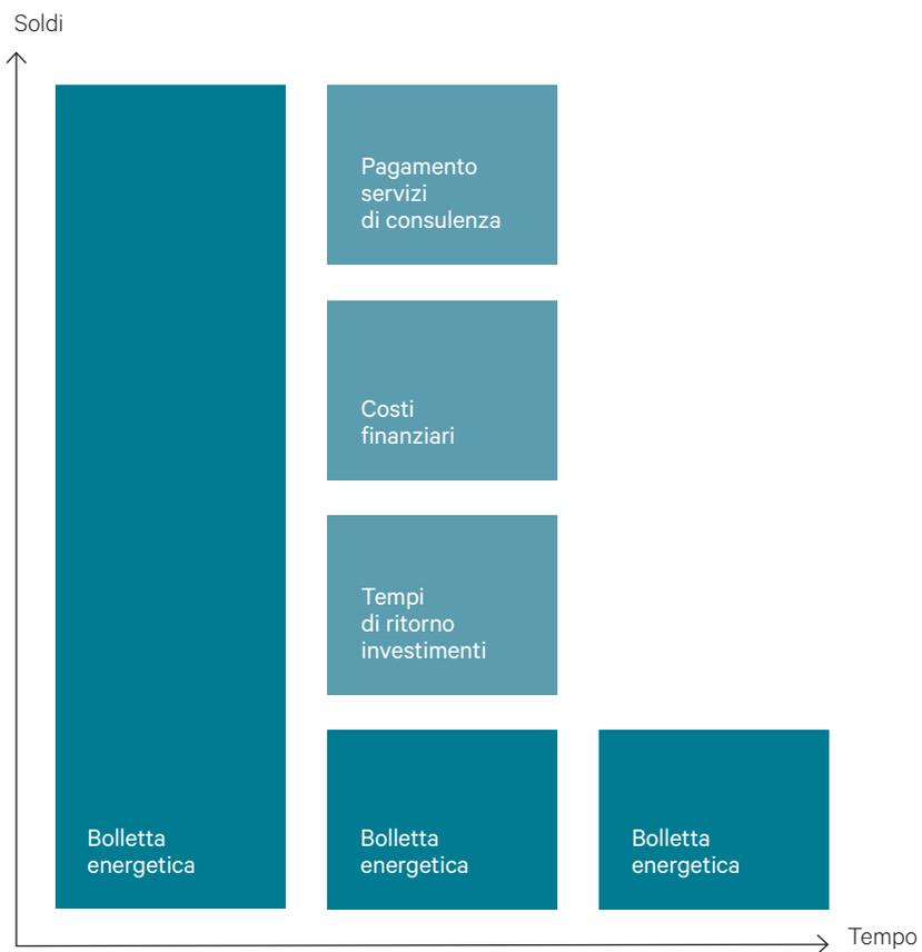
Schema di funzionamento delle ESCo.
